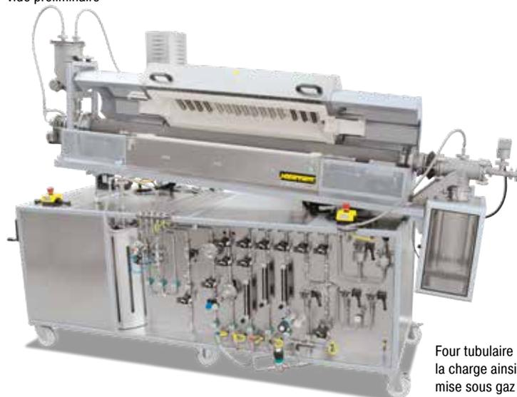
Four tubulaire rotatif RSRC 120/1000/11 H<sub>2</sub> avec régulation trois zones, régulation par la charge ainsi que tube de travail en FeCrAl, système de chargement et installation de mise sous gaz 4 pour le fonctionnement à l'hydrogène
