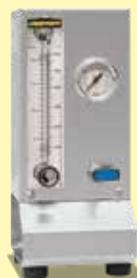
Panneau de gaz pour un gaz inerte ou réactif non combustible (N<sub>2</sub>, Ar, He, CO<sub>2</sub>, air, gaz de formage)
