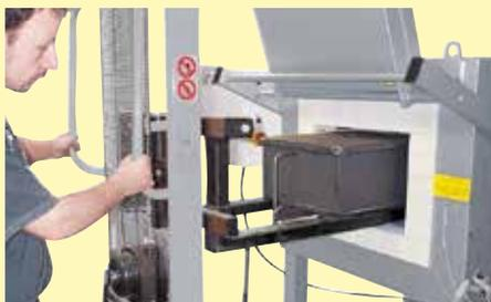
Travail avec caisson d'alimentation en gaz pour atmosphère gazeuse protectrice à l'aide d'une navette de chargement
