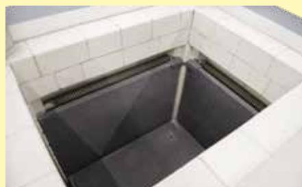
Revêtement des côtés et de la sole avec protection à plaques de carbure de silicium pour four puits S 73/HS
