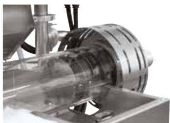
Bride avec insert de protection contre les irradiations de chaleur (installation d'alimentation en gaz 15)
